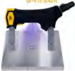
按压工作开关一次 即可连续磁化
